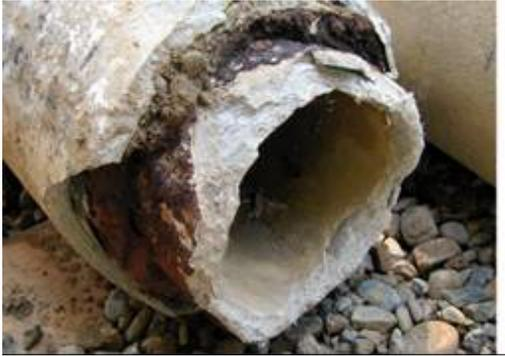
Tubería de fibrocemento
