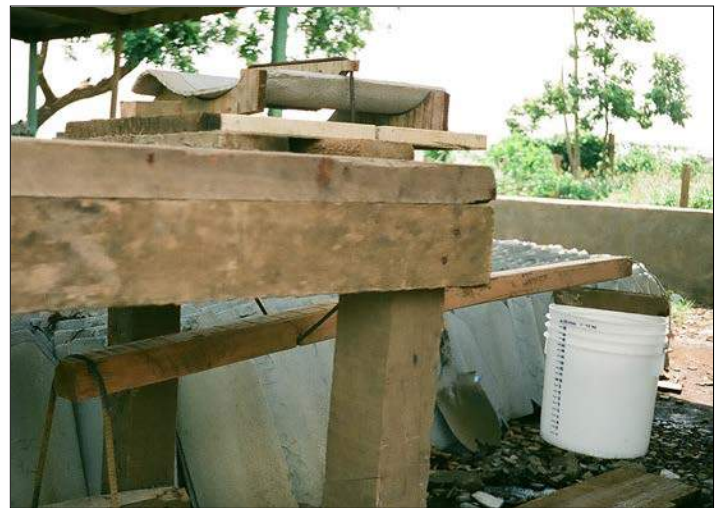
Pruebas de resistencia de las tejas a la flexión.
